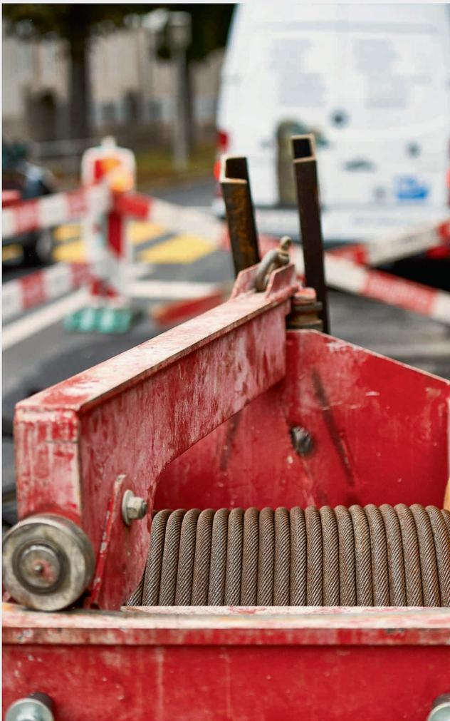
Fig. 6 Der Strang wird vor der Platzierung im alten Rohr durch ein konisches Gesenk gezogen. Im Bild: die Kabelrolle.
